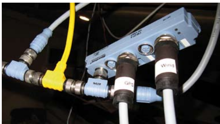
El NMEA 2000 permite conexiones en serie y elimina las habituales confusiones de colores y las incompatibilidades Talker – Listener del NMEA 0183
