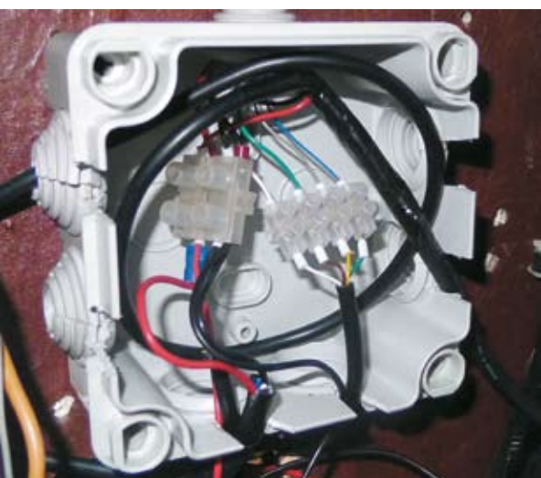
El NMEA 2000 ha terminado con las regletas de finos cables de colores del NMEA 0183 conectados al estilo "nido de culebrillas"
